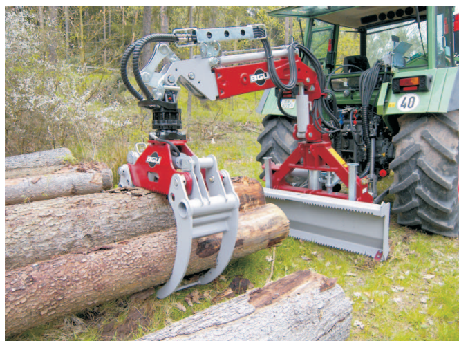
Rys. 3. Jednowysięgnikowy chwytak zrywkowy BGU HRZ [7]
