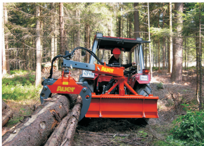
Rys. 2. Chwytak Auer 1700 SW z ręcznie wysuwającym teleskopem [6]
