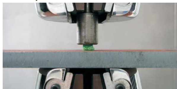
Rys. 5. Widok próbki ułożonej na maszynie wytrzymałościowej po wykonaniu próby ściskania
