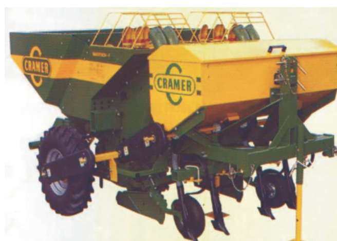
Rys. 2. Sadzarka taśmowo-czerpakowa Cramer Junior z siewnikiem do wysiewu nawozów Fig. 2. Strip-bucket potato planter Cramer Junior with fertilizer spreader
