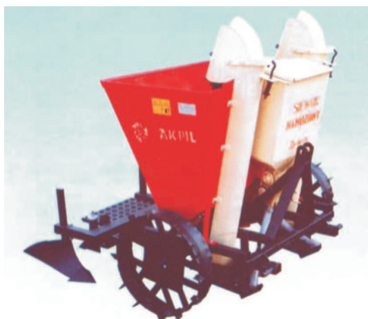
Rys. 1. Sadzarka łańcuchowo-czerpakowa S227 AKPIL z rzędownym dozownikiem nawozu Fig. 1. Chain-bucket potato planter S227 with row fertilizer applicator
