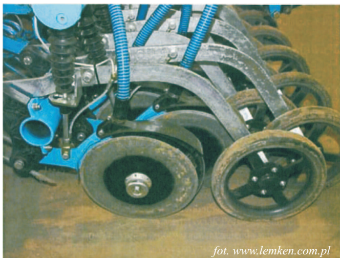
Rys. 7. Redlice z systemem automatycznego docisku Fig. 7. Coulter with automatic pressure regulator
