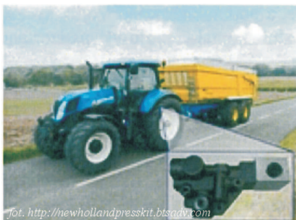
Rys. 4. Ciągnik New Holland z przyczepą wyposażoną w inteligentny system hamulcowy Fig. 4. New Holland tractor with a trailer equipped with an intelligent trailer braking system
