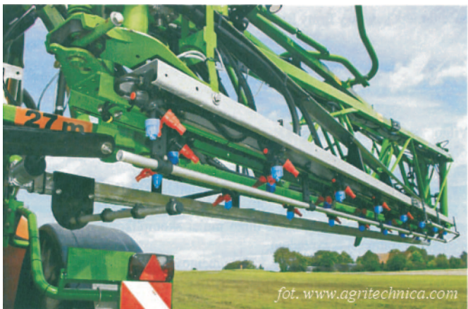
Rys. 8. Układ myjący BoomWash Fig 8. BoomWash-Automatic outer cleaning of spraying booms
