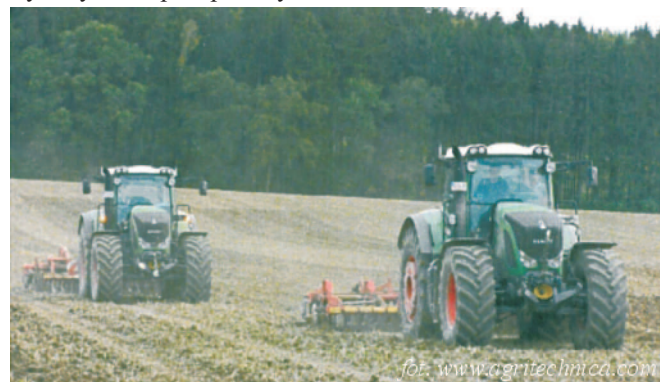
Rys. 1. Ciągniki FENDT pracujące w systemie GuideConnect Fig. 1. FENDT tractors working in the GuideConnect system
