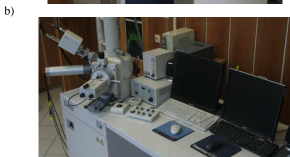
Fig. 3. View of: a) Thermo ARL Quantris emission spectrometer, b) Hitachi S-3000N scanning microscope Rys. 3 Widok: a) spektrometr emisyjny Thermo ARL Quantris, b) mikroskop skaningowy Hitachi S-3000N
