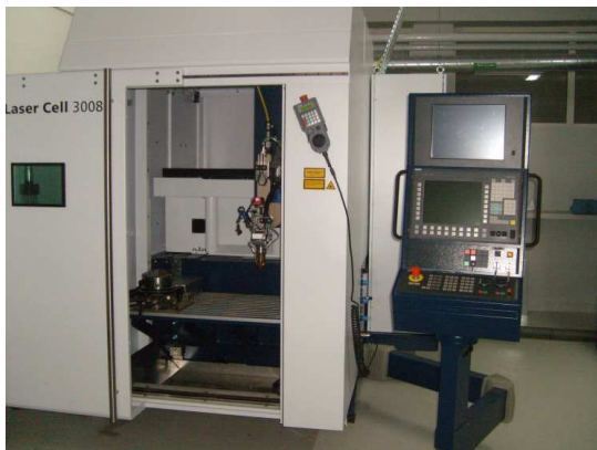
Rys. 1. Widok urządzenia do laserowego stapiania proszków metali firmy TRUMPF znajdującego się w Laboratorium Przemysłowego Instytutu Maszyn Rolniczych w Poznaniu
