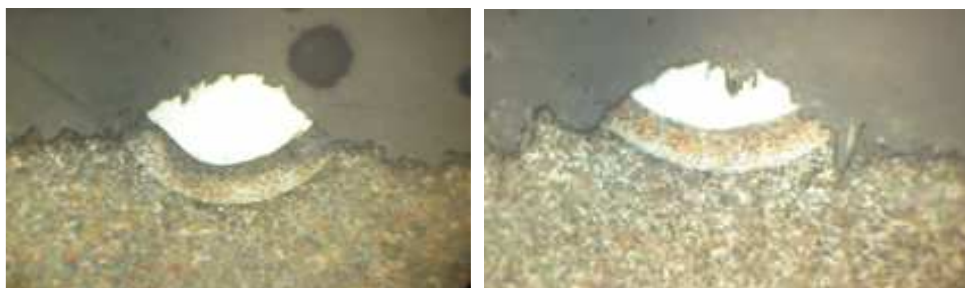
Rys. 4. Widok przykładowej napoiny w przekroju poprzecznym (w wariacie 1); z prawej strony, próbka po dodatkowym zabiegu laserowego dogładzania, powiększenie 100x, mikroskop MO MET3-XJP6
