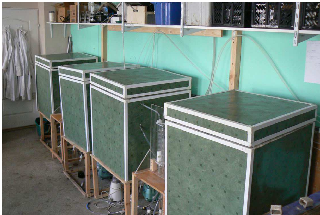
Rys. 2. Czterokomorowy bioreaktor do badania procesów rozkładu substancji organicznych Fig. 2. Four-chamber bioreactor for investigation of processes of organic substances decomposition
