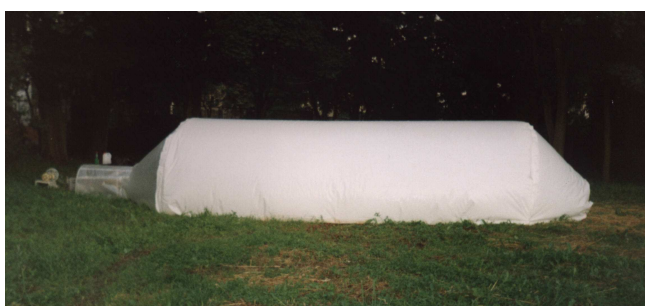
Rys. 2. Tunel aerodynamiczny do badań emisji gazowych
