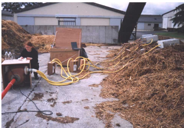
Rys. 1. Pomiar gazowy z powierzchni kompostowanego obornika.
